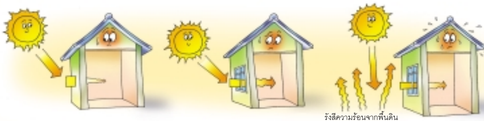
การนำความร้อนผ่านผนังทึบของอาคาร
