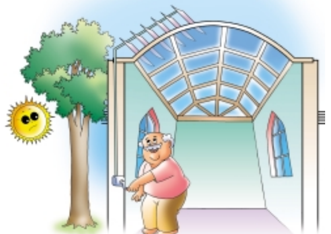
เมื่อไม่มีแสงแดดส่องโดยตรงบนหลังคา Skylight ให้ปรับแผงเกล็ดเปิดรับแสงธรรมชาติได้เต็มที่
