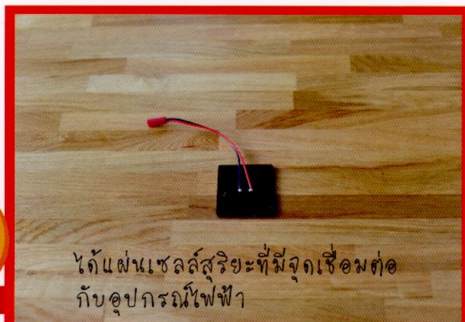
ต่อสายไฟเข้ากับขั้วที่อยู่บนหลังแผ่นเซลล์สุริยะ
