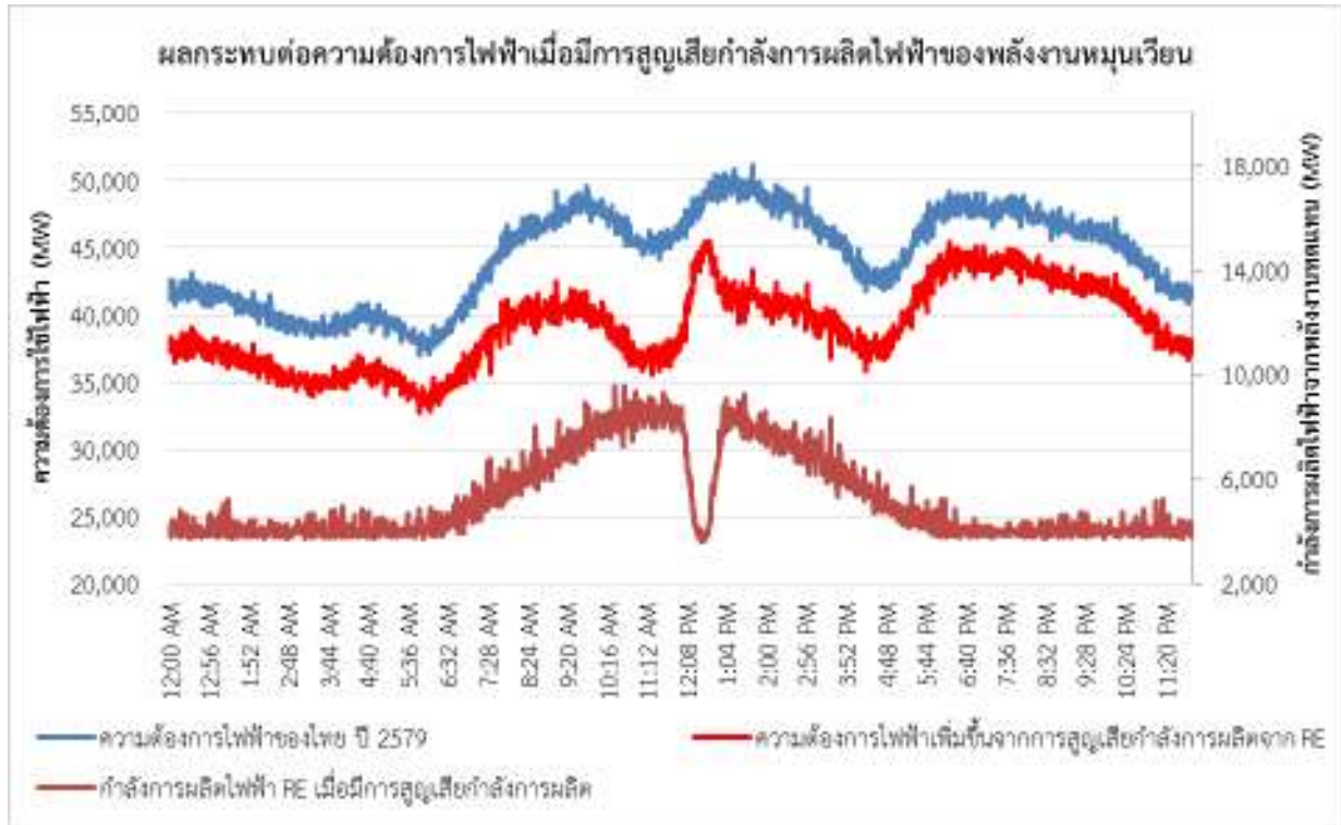
รูปที่ 8.4 : ตัวอย่างของความต้องการไฟฟ้าจะเพิ่มสูงขึ้นทันทีเมื่อมีการสูญเสียกำลังการผลิตไฟฟ้าจากพลังงานหมุนเวียน
