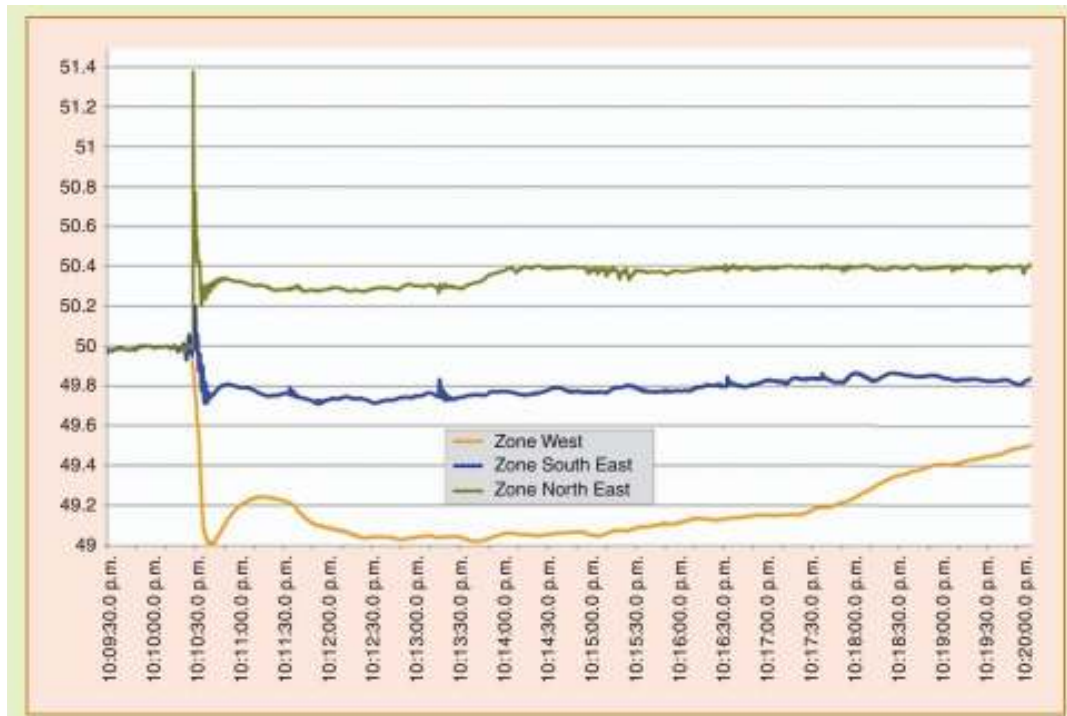
รูปที่ 2.70 : บันทึกค่าความถี่หลังเกิดเหตุการณ์แยกตัวของระบบในโครงข่าย ENTSO-E ในปี 2006
