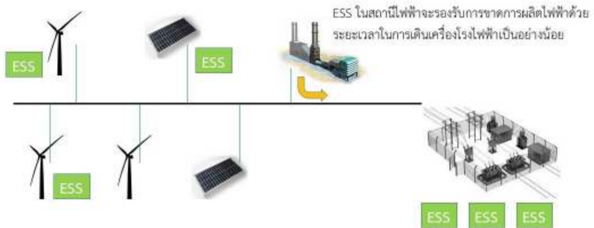
รูปที่ 6.11 : เครื่องกำเนิดไฟฟ้าในระบบสามารถเดินเครื่องชดเชยปริมาณการผลิตไฟฟ้าส่วนขาดจากระบบผลิตไฟฟ้าพลังงานหมุนเวียน
