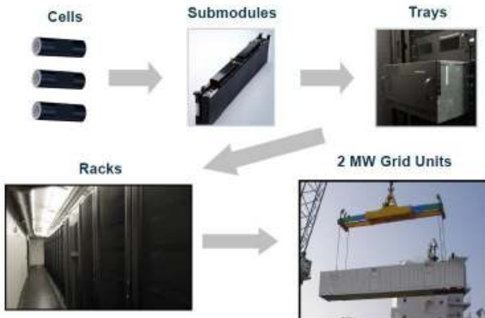
รูปที่ 2.108 : โครงสร้างโมดูลของแบตเตอรี่ชนิด Lithium-ion
