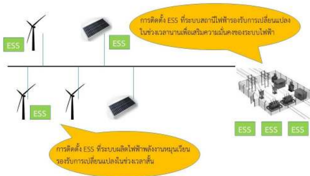
รูปที่ 6.10 : แนวคิดในการเสริมความมั่นคงของระบบไฟฟ้า โดยการติดตั้งระบบกักเก็บพลังงานในสถานีไฟฟ้าของระบบไฟฟ้าที่มีการผสมผสานพลังงานหมุนเวียน
