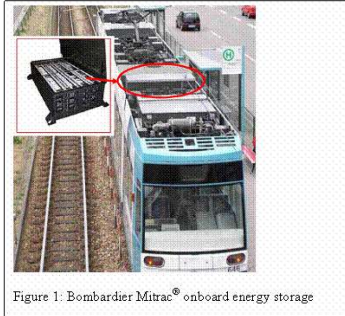
รูปที่ 4.27 : รถไฟของบริษัท บอมบาร์ดิเออร์ ทรานสปอร์ตเทชันที่ติดตั้งซูเปอร์คาปาซิเตอร์
