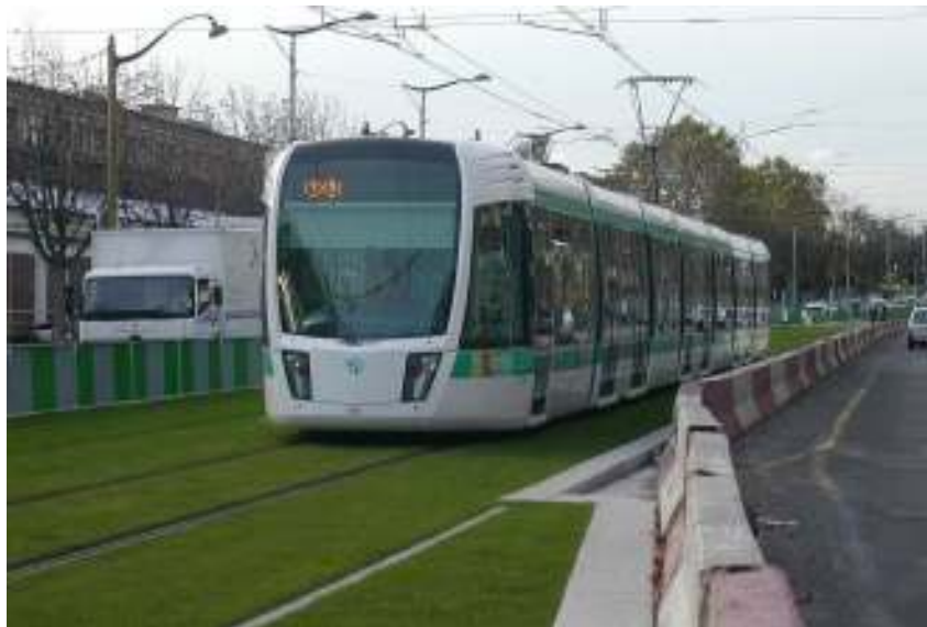
รูปที่ 4.28 : รถไฟฟ้าสาย Paris T3 ที่ติดตั้งซูเปอร์คาปาซิเตอร์
