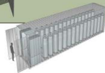
รูปที่ 2.102 : โครงสร้างโมดูลของแบตเตอรี่ชนิด Zinc-Flow ขนาด 25MW/75MWh
