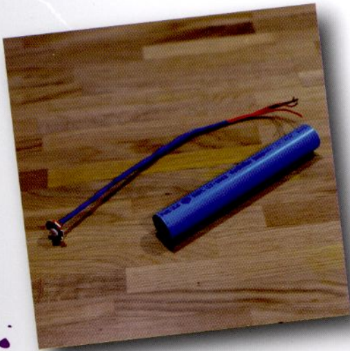
เตรียมท่อ pvc เพื่อ มาทำเสาของโคมไฟ
