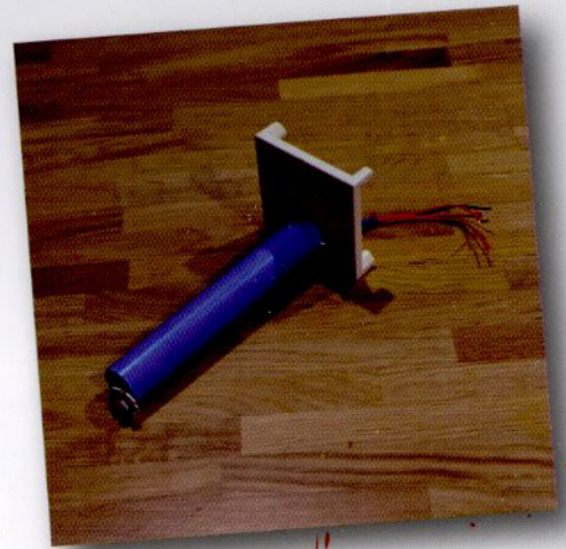
ประกอบชุดท่อ pvc ที่มี หลอด LED อยู่ภายในท่อ เข้ากับฝาของกล่องอเนกประสงค์
