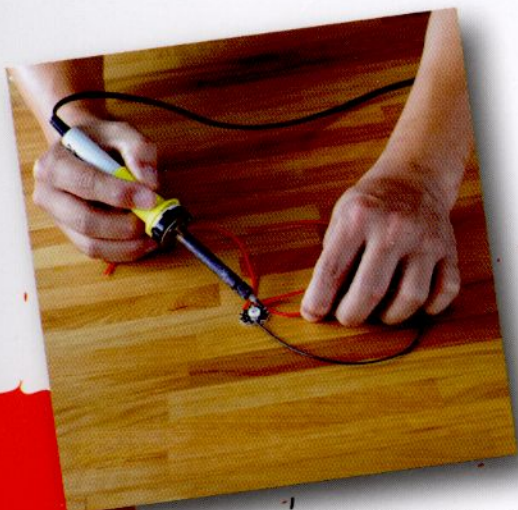
ต่อหลอด LED เข้ากับ แผ่นระบายความร้อนและชุดสายไฟ
