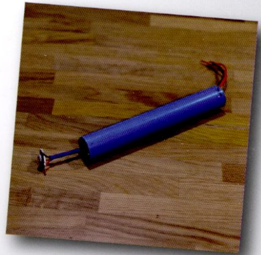
ร้อยชุดสายไฟ LED ลงในท่อ pvc
