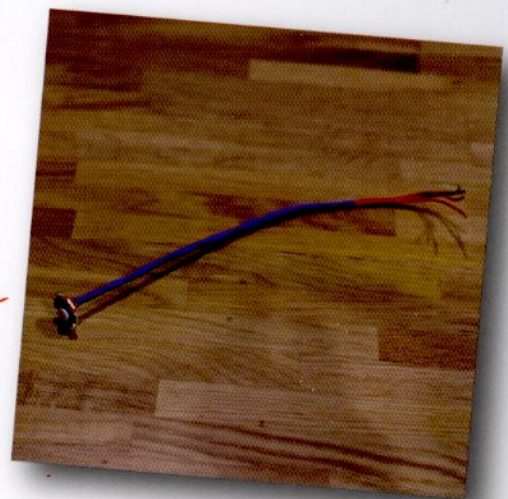
ใช้ที่อ่อ่นมาหุ้มกันสายไฟ เพื่อให้เกิดความแข็งแรง
