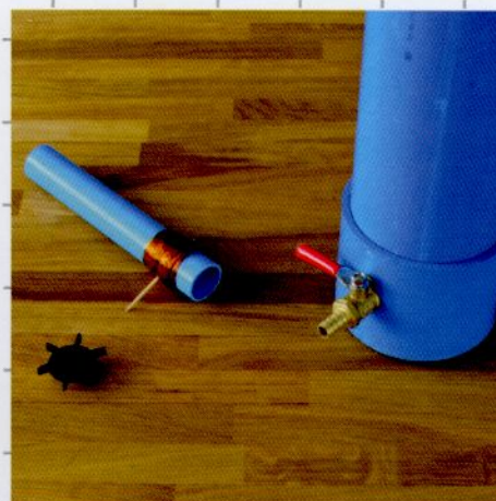
เตรียมก้านหันน้ำ มาประกอบเข้ากับ เครื่องกำเนิดไฟฟ้า
