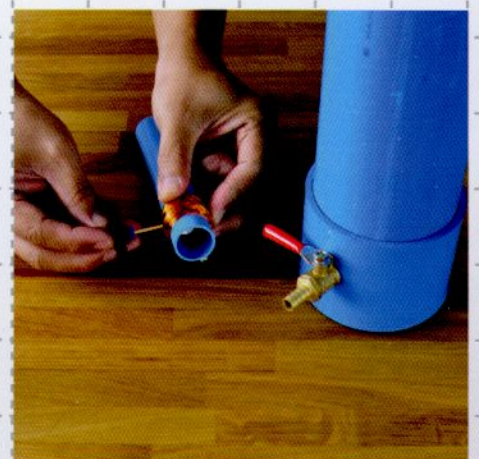
ประกอบก้านหันน้ำ เข้ากับแกนไม้จิ้มฟัน ที่ประกอบชุดแม่เหล็กลงไปแล้ว
